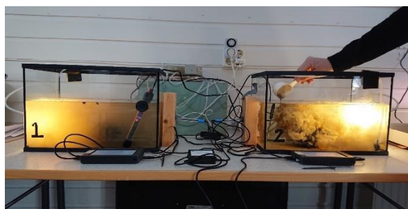
Bild 5 Mätning av musslors filtrering försök 2 – Tillsättning av 1 dl upplöst lera-Innan filtrering 20190121
