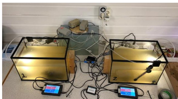
Bild 4 Mätning av musslors filtrering vid olika temperaturer- Innan filtrering 20190117
