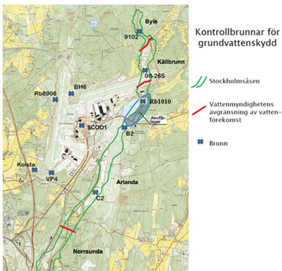
Figur 15. Kontrollbrunnar för grundvattenprovtagning år 2021
