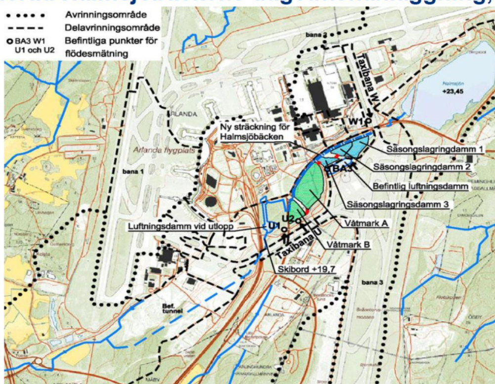
Figur 30 Planerad dagvattenanläggning vid Halmsjöbäcken (Swedavia MKB s65).
