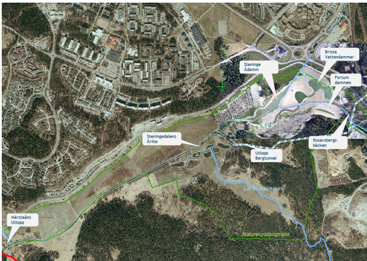
Figur 28 Steningedalens Vattenlandskap. Avrinningsområde i rött, nuvarande vattendrag i blått, markbegränsningslinjer och dammar i ljusgrönt, naturskyddsområde i prickad grönt. Den planerade Fortumdammen inlagd från karta (Fortum ritning 2010). Rosersbergsbäckens gamla anslutning till Märstaån syns fortfarande i blått från primärkartan. ©Lantmäteriet Gävle 2011 Medgivande I2011/0097, ©SMHI2011, ©Sigtuna kommun 2011
