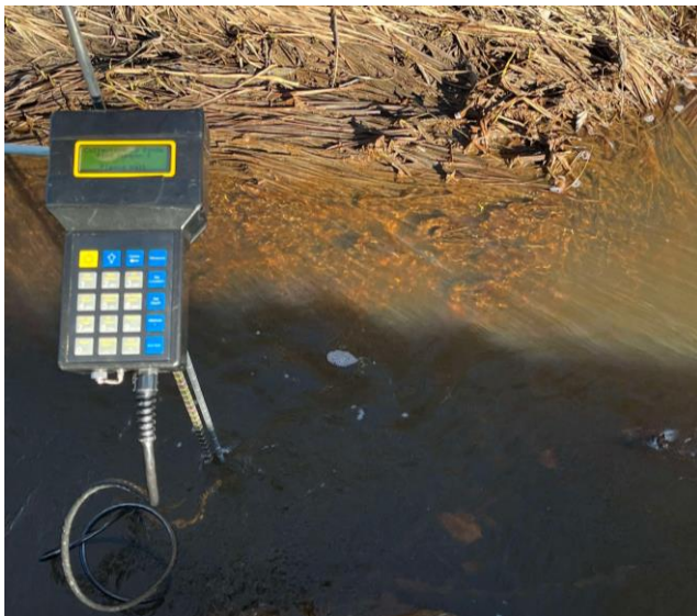
Figur 14: Uppställning av flödesmätning med ADV i Kättstabäcken.
